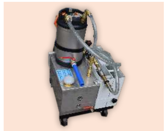
Маслоотделитель MO5440, фильтрация посторонних масел без расходных материалов
